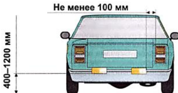
Рис. 31.1. Установка задних противотуманных фар на автомобиле.
