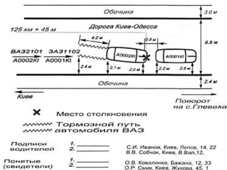
Рис. 2.3. Пример составления схемы дорожно-транспортного происшествия (способ перпендикуляров).
