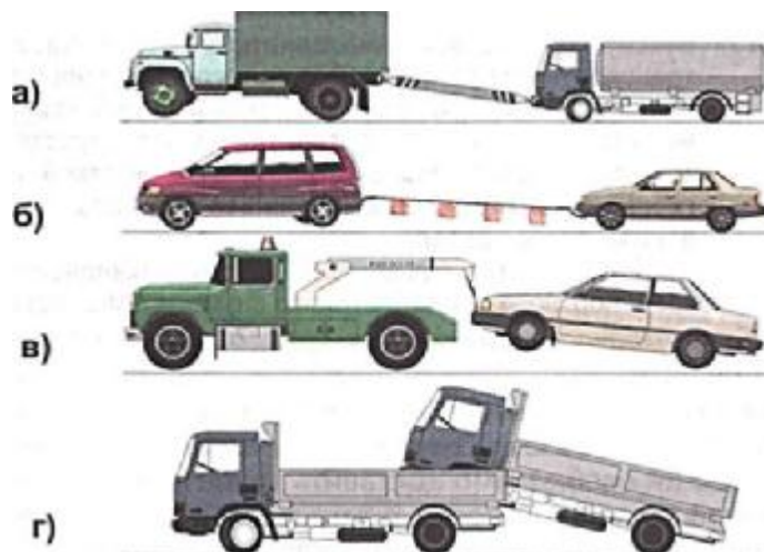
Рис. 23.1. Разрешенные методы буксировки.
