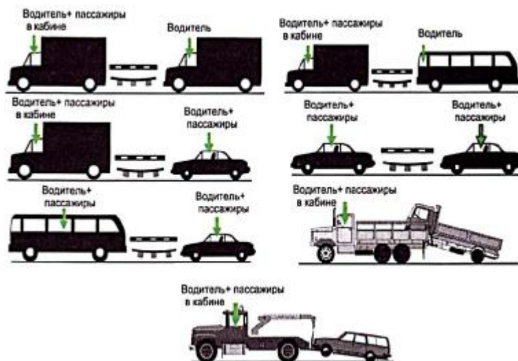
Рис. 23.3. Места разрешенной перевозки людей при буксировке (стрелкой указаны места, где перевозка людей разрешается).
